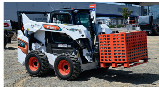
Der Prototyp S7X arbeitet vollelektrisch – er wird von einer 60,5-kWh-Lithium-Ionen-Batterie gespeist und soll neben einer auffallend langen Betriebszeit über noch mehr Leistungskraft verfügen als das Vorgängermodell T7X.
